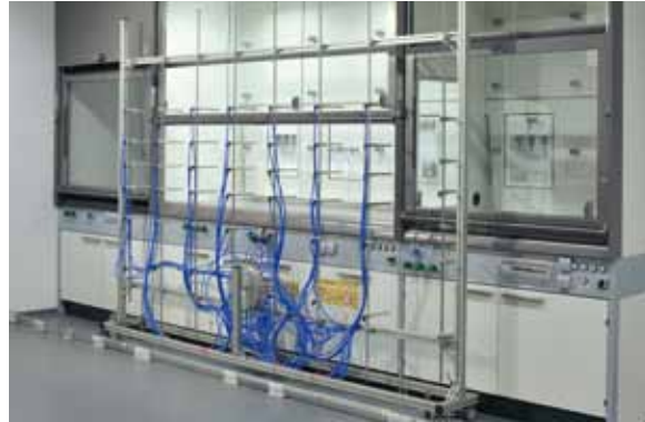
EN 14175-6, regolazione dell'aspirazione di tipologia controllata secondo 5.4
